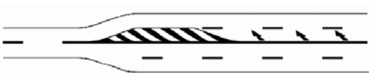
Marcaj la ingustarea drumului cu o banda pe sens
